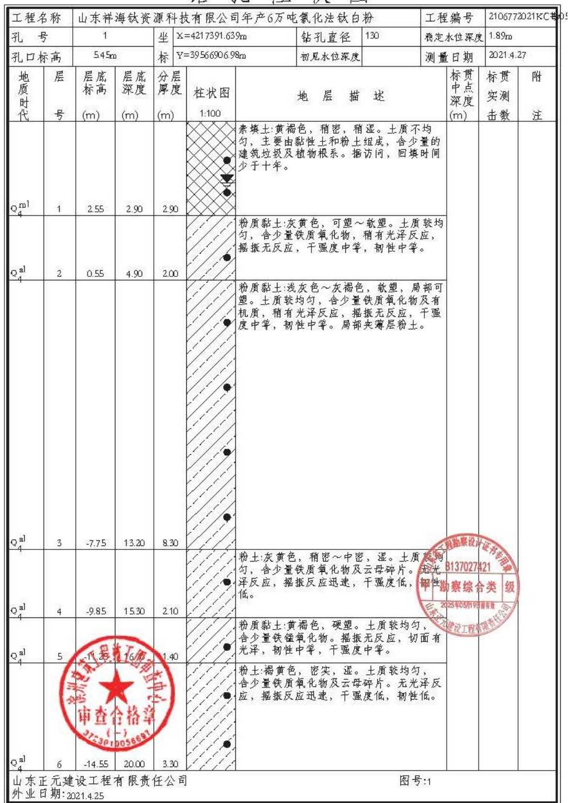
图 6.3-3 拟建工程所在区域钻孔柱状图
